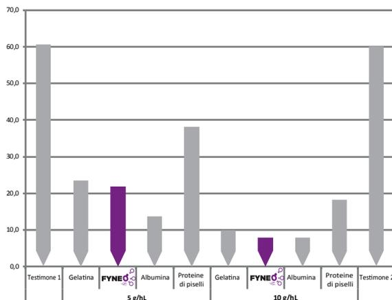
Analisi della torbidità (in NTU) dopo una chiarifica di 14 giorni a temperatura ambiente in laboratorio.
