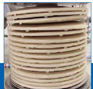
Deformazione degli elementi dopo il trattamento termico
