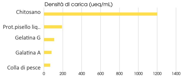
➤ Dopo l'analisi della densità di carica dei formulati per la chiarifica, è stato utilizzato l'apparecchio Turbiscan® che consente di misurare i parametri relativi alla qualità della chiarifica nel tempo. Tramite un raggio laser è possibile misurare in ogni momento la trasmissione del liquido (quindi la sua "limpidezza"). Più elevato è il valore di trasmissione, più il prodotto di chiarifica utilizzato ha una maggiore capacità di flocculare e quindi di chiarificare il vino.
