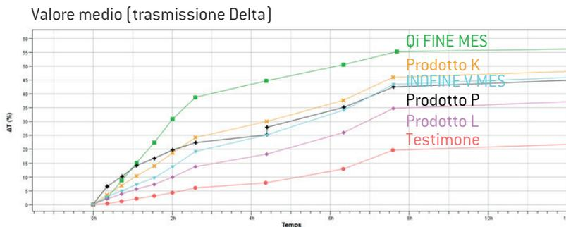
In questo caso, il comportamento di **Qi FINE MES** dà prova di una capacità di flocculazione molto rapida rispetto agli altri agenti chiarificanti, con un valore di trasmissione medio del 40%, in 3 ore e quindi visibile ad occhio nudo. Per gli altri prodotti di chiarifica occorre aspettare tra le 6 e le 8 ore. **Bordeaux Rosé preimbottigliamento 2018.**
