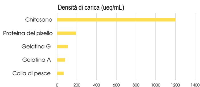
Previa analisi della densità di carica dei formulati testati per il collaggio, con l'ausilio di \*Turbiscan®, è stata valutata la qualità della chiarifica nel tempo di ogni formulazione.
